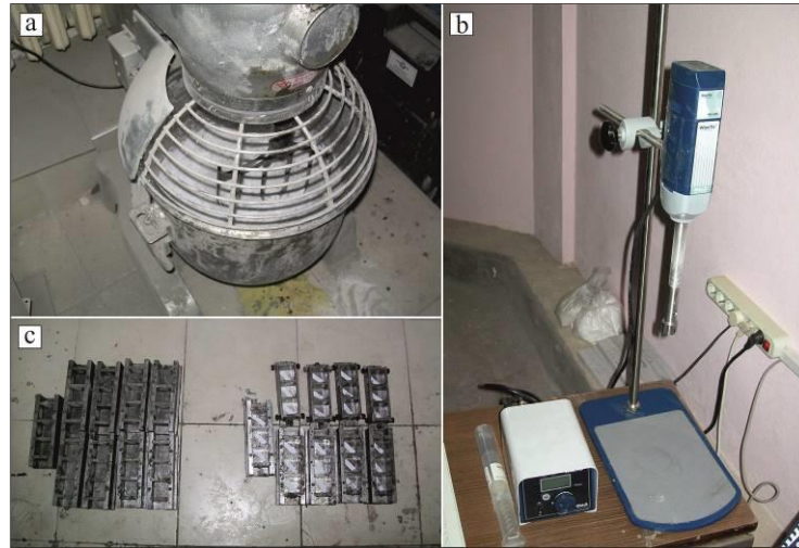
Şekil 3.21. Harç karışımlarının hazırlanması a) Laboratuvar tipi harç mikseri, b) Hızlı karıştırıcı, c) Numunelerin kalıplanması
