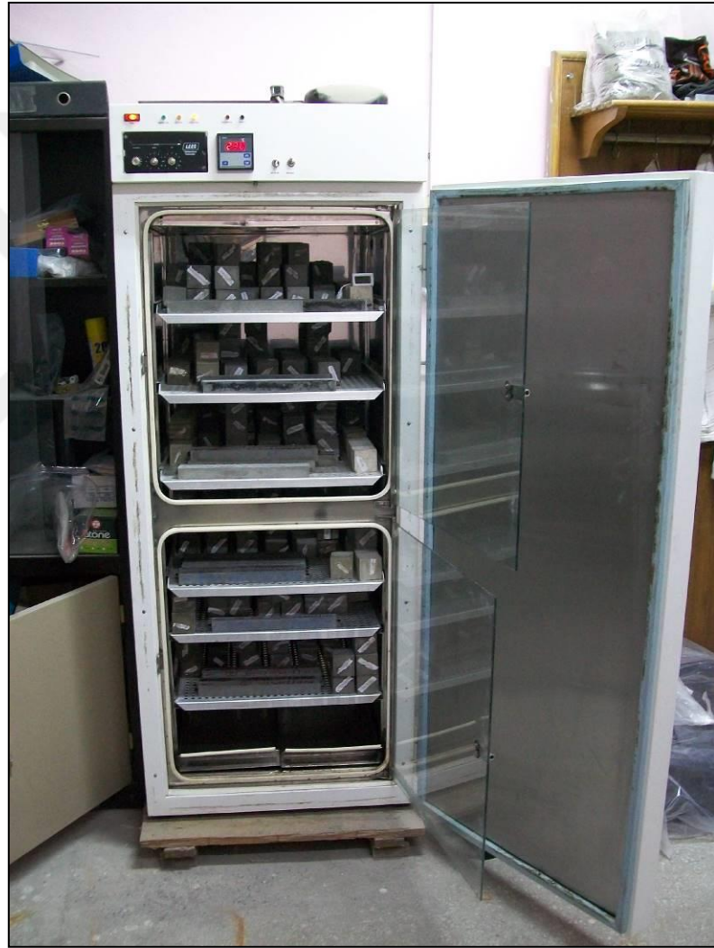
Şekil 3.27. Numunelerin kürlenmesi ve kullanılan kür kabini
