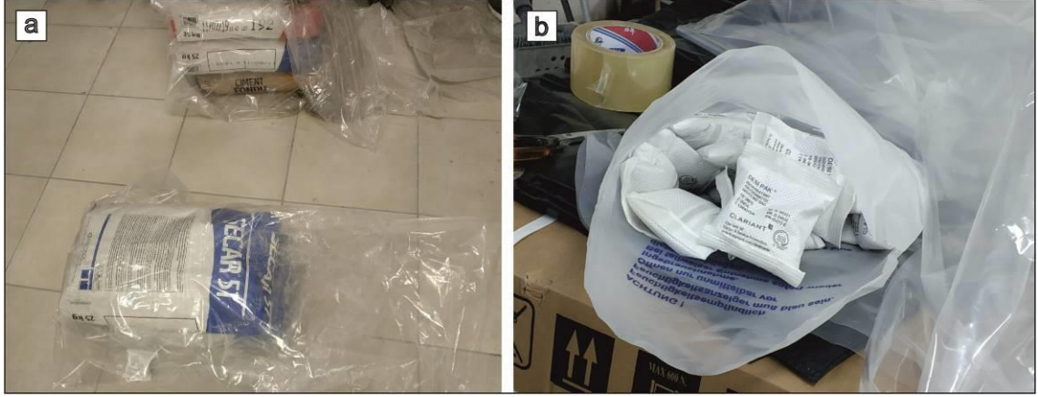
Şekil 3.1. Numunelerin saklanması a) Numunelerin plastik torbalara konulması, b) Poşet içerisindeki nemi tutabilmek amacıyla kullanılan bentonit kil nem tutucu
