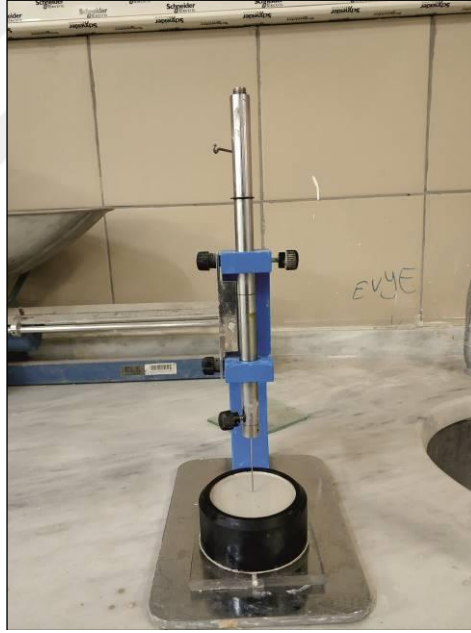
Şekil 3.28. Vicat aparatı ile priz sürelerinin tayin edilmesi
