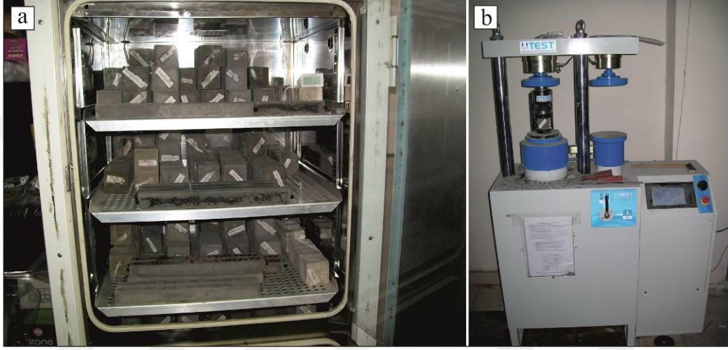
Şekil 3.29. Basınç dayanımı testi a) Küp numuneler, b) Basınç dayanımı testi için kullanılan pres
