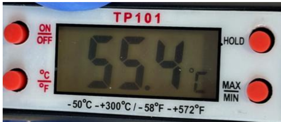
Şekil 3.8. Solüsyonun kanal dışarısında 55 °C'ye ısıtılması
