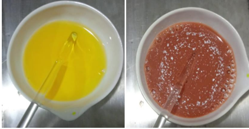
Şekil 6.8. Klor tayini için yapılan testin renk değişimi
