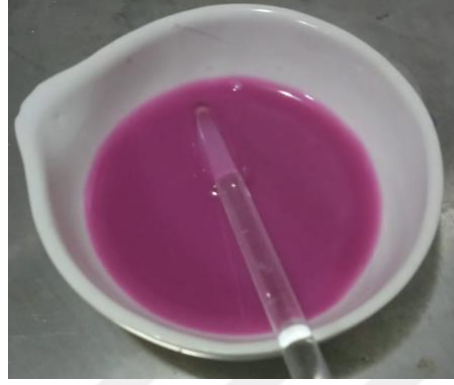
Şekil 6.6. P_m testindeki renk gözlemi
