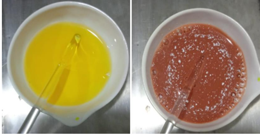
Şekil 6.8. Klor tayini için yapılan testin renk değişimi
