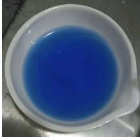
Şekil 6.9. Kalsiyum sertliği deneyi sırasındaki renk değişimi
