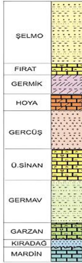
Şekil 7.5. B bölgesine ait muhtemel sondajı yapılan formasyonların genel stratigrafisi (TPAO,2017)
