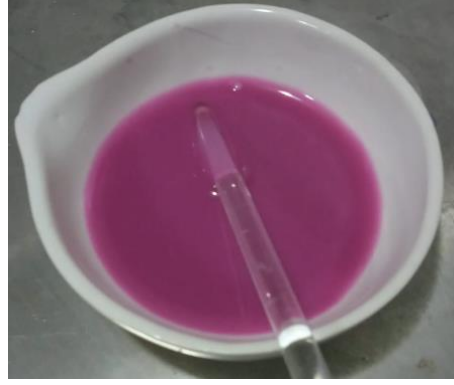
Şekil 6.6. P_m testindeki renk gözlemi
