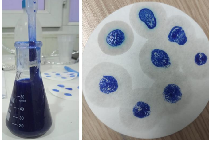
Şekil 6.10. MBT deneyinde filtre kâğıdında turkuaz renk halkası
