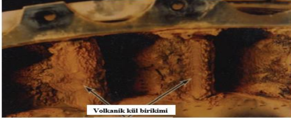
Şekil 2.20: Volkanik kül birikim etkisine maruz kalmış türbin bıçak kesiti (Chen ve Zhao, 2015).
