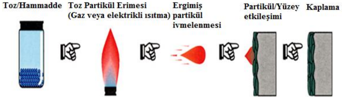
Şekil 2.1: Termal sprey kaplama prosesinin şematik görünümü (Özgürlük, 2016).
