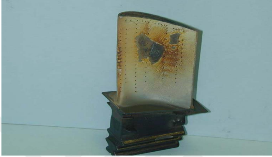
Şekil 2.14: Yüksek sıcaklık etkisine maruz kalmış gaz türbin bıçağının hasarı (Stolle, 2009).
