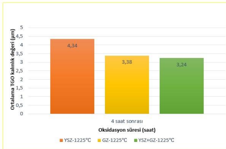
Şekil 4.21: TBC sistemlerine ait 4 saatlik vermikülit (VM) infiltrasyonu sonrası TGO tabakası kalınlık-zaman değişim grafiği.
