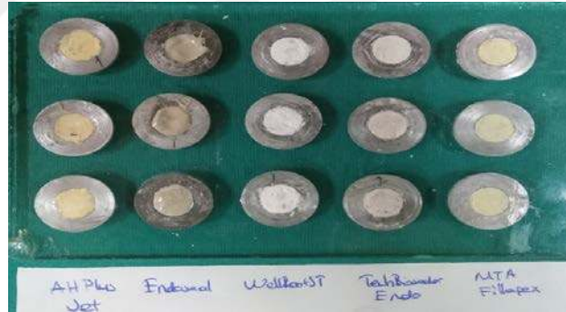
Resim 15. Sertleşme süresi testi için hazırlanan örnekler
