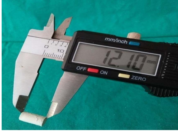
Resim 8. Boyutsal deęişim testinde örneklerin ölçülmesi
