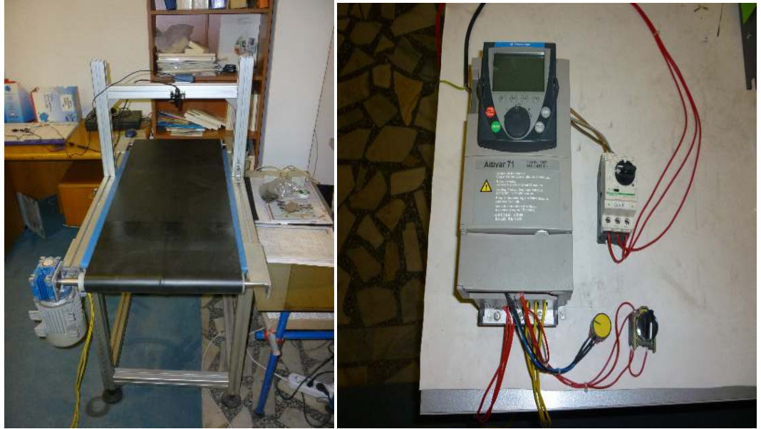
Şekil 2.1 Yürüyen bant, motor sürücüsü ve hız kontrolünde kullanılan potansiyometre.
