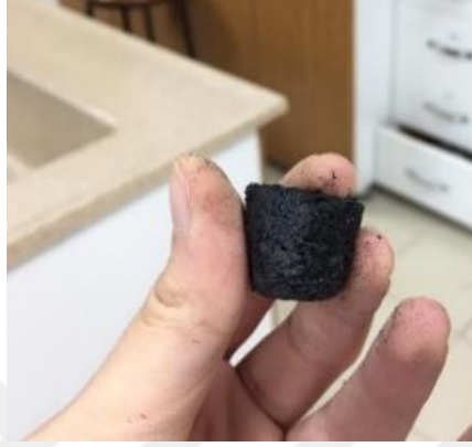
Resim 3.6 Hızlı piroliz sonrası üretilen aktif karbon numune örneği.
