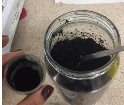
Resim 3.5 % 30'luk o-H 3 PO 4 ile aktifleştirilmiş kamış numunesi.
