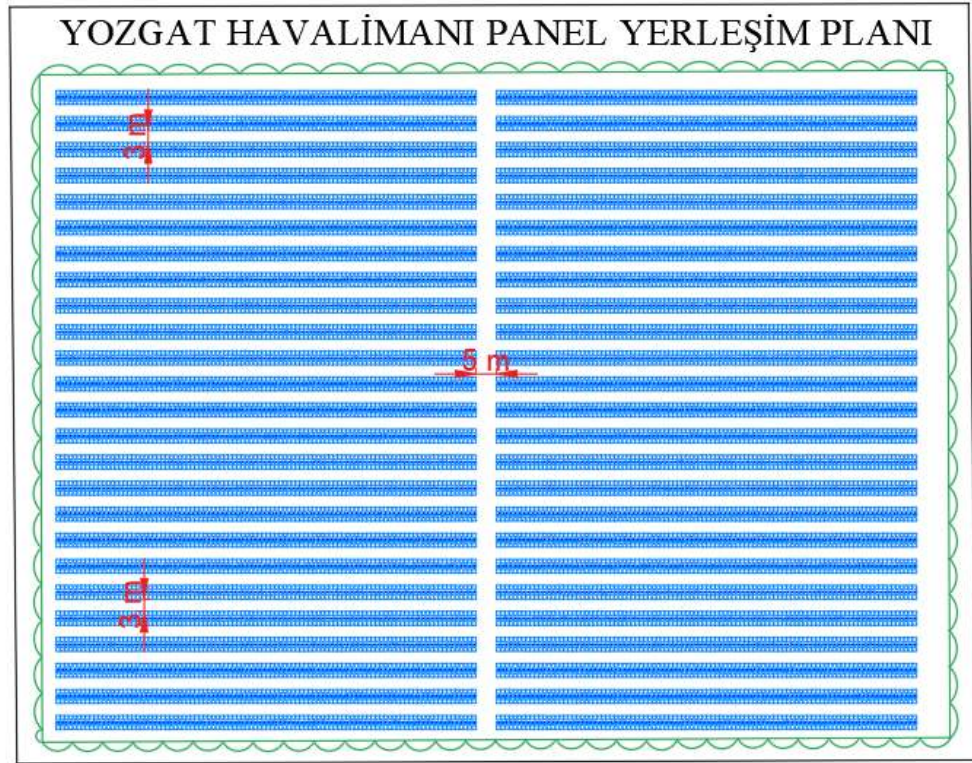
Şekil 4.11 PV hücrelerin yerleşim planı
