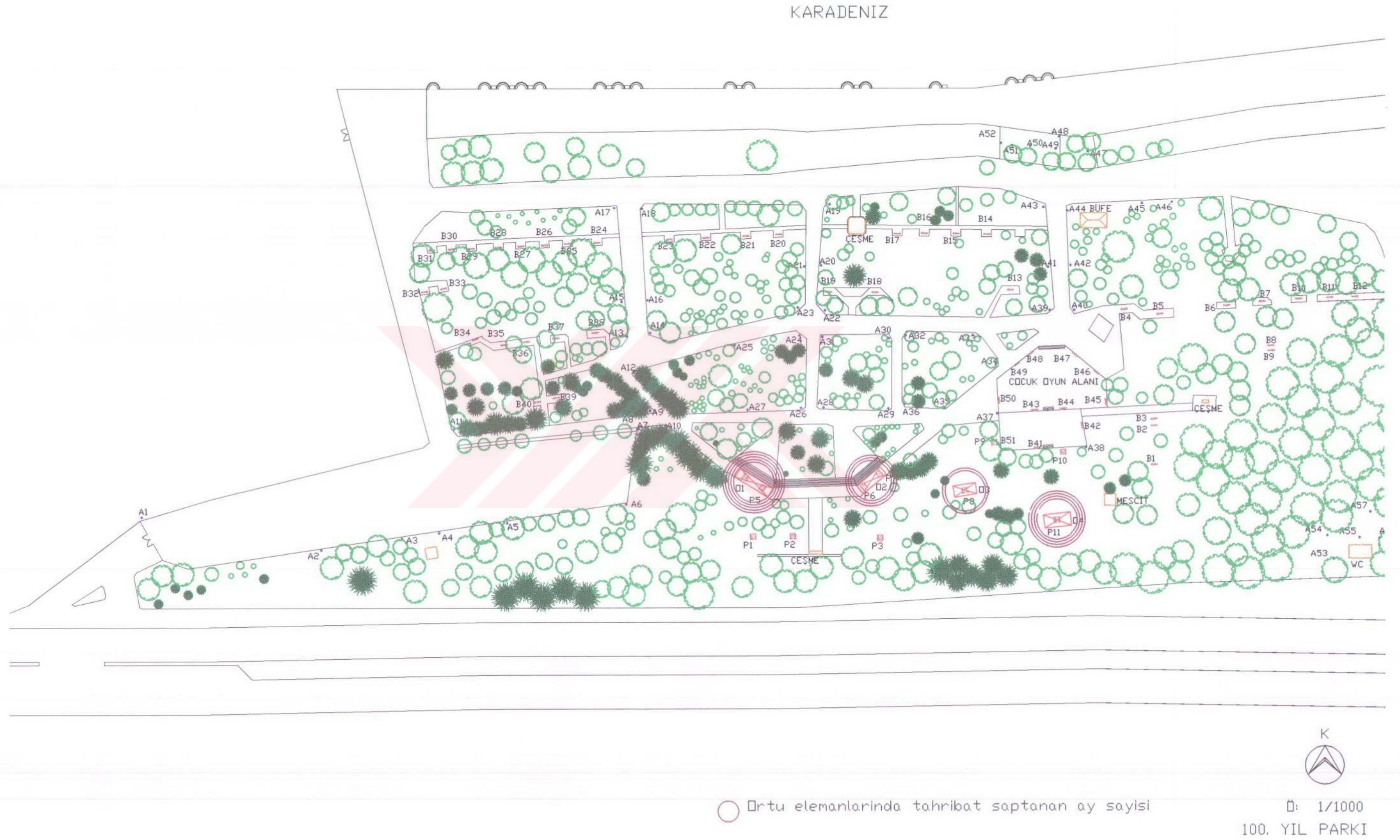
Şekil 58 . Örtü elemanlarındaki hasar dağılımı
