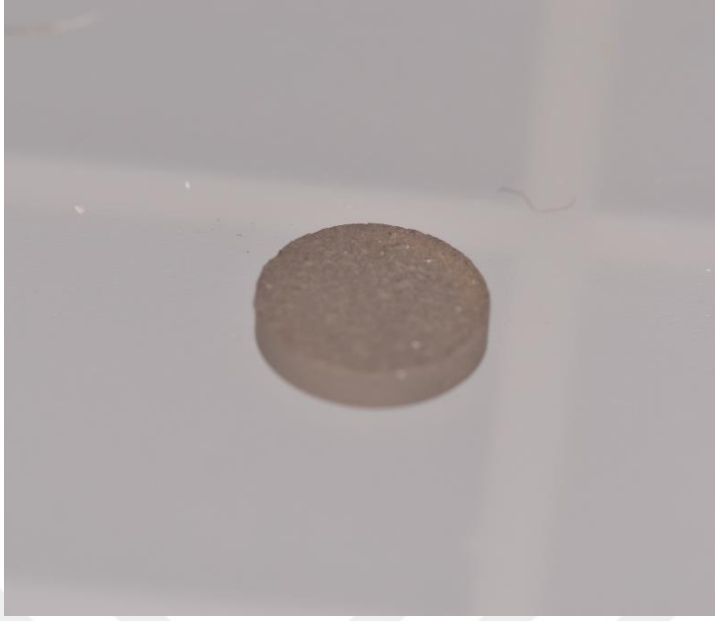
Şekil 3-3: C Grubu (Grade 4 SLActive) disk yüzeyi
