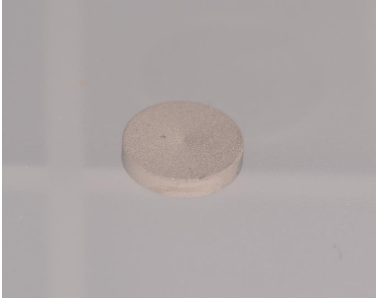
Şekil 3-2: B Grubu (Grade 4 SLA) disk yüzeyi
