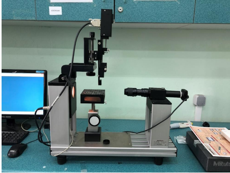
Şekil 2-17: Günümüzde temas açısının dijital ölçümü yapılan gonyometre
