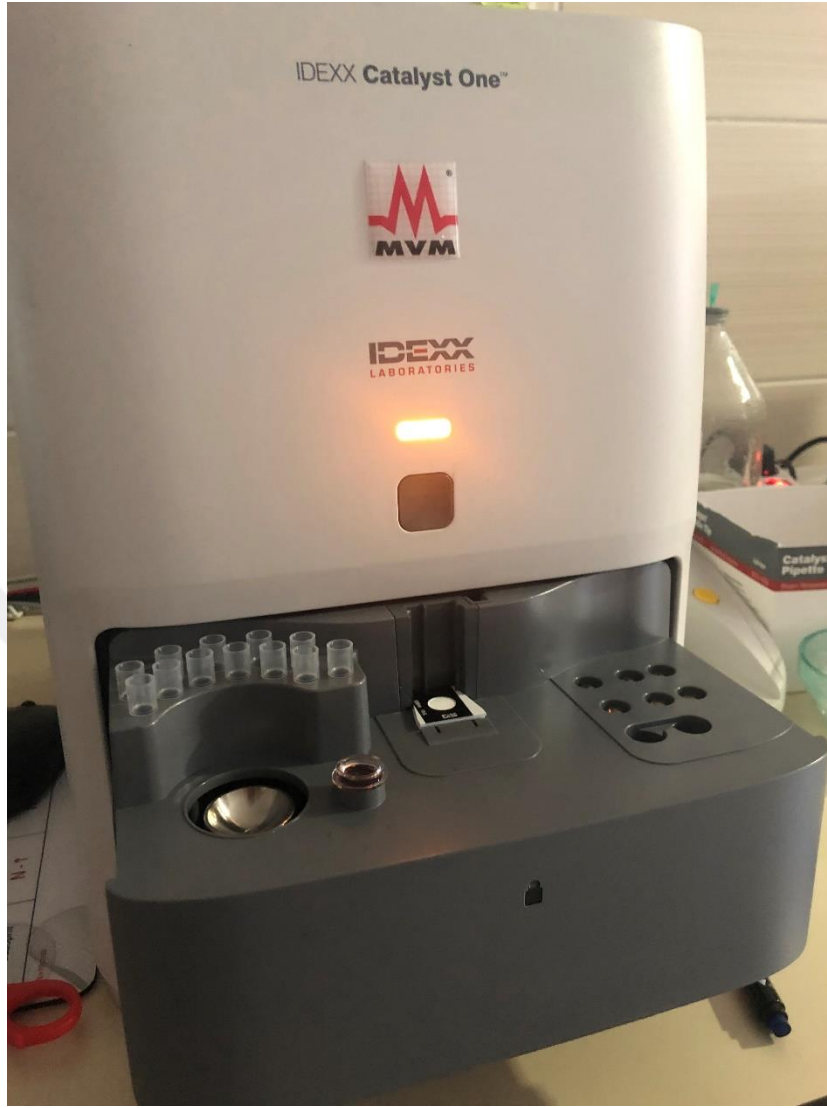
Şekil 3-18: Total kolesterol ve trigliserit düzeyi ölçülen cihaz
