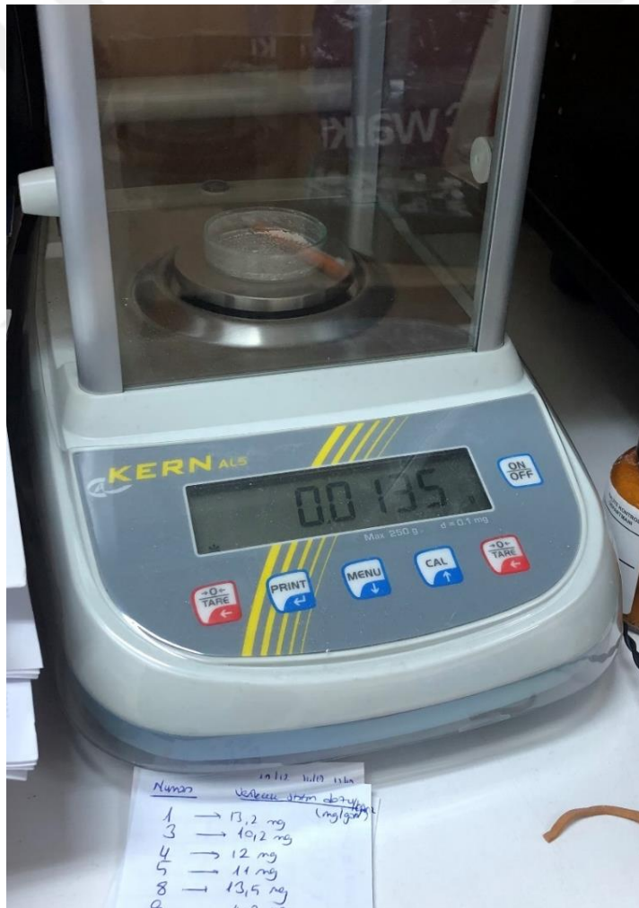
Şekil 3-19: Statin miktarlarının hassas elektronik terazide ayarlanması
