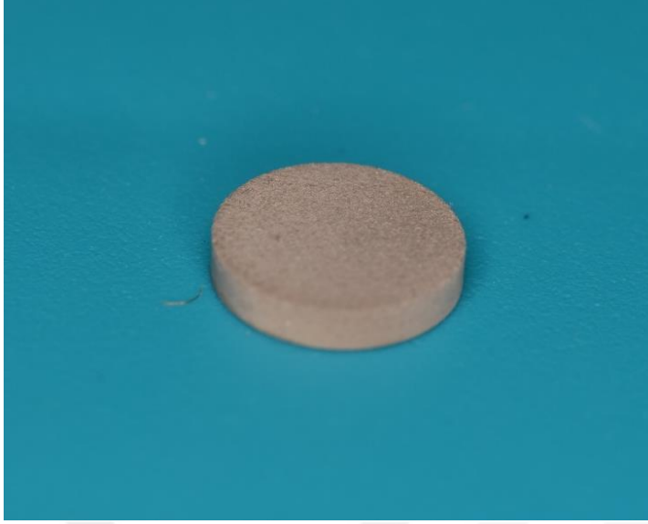
Şekil 3-5: E Grubu (Roxolid SLActive) disk yüzeyi
