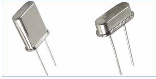
Şekil 3.3. Kistal Osilatör Devre Elemanları
