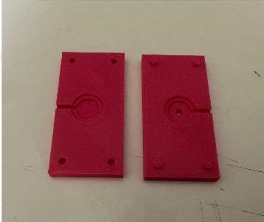
Şekil 3.10. Üç Boyutlu Yazıcı İle Çift Taraf Elektrotlu Kristaller İçin Bastırılan Tasarım
