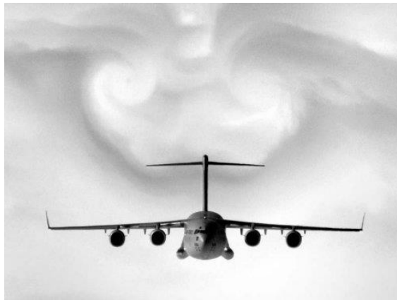
Şekil 2.9 : Kanat ucu girdapları.
