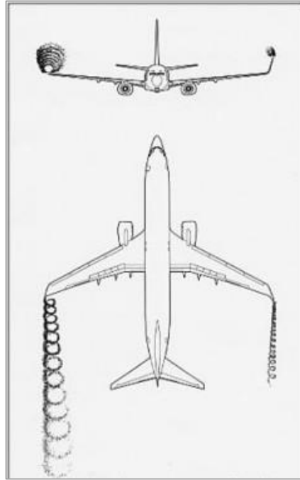
Şekil 4.1 : Wingletsiz/li kanat ucu girdapları.
