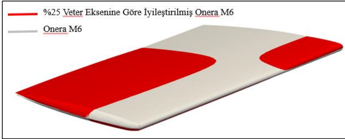
Şekil 8.50. %25 veter eksenine göre iyileştirilmiş kanat geometrisinin karşılaştırması
