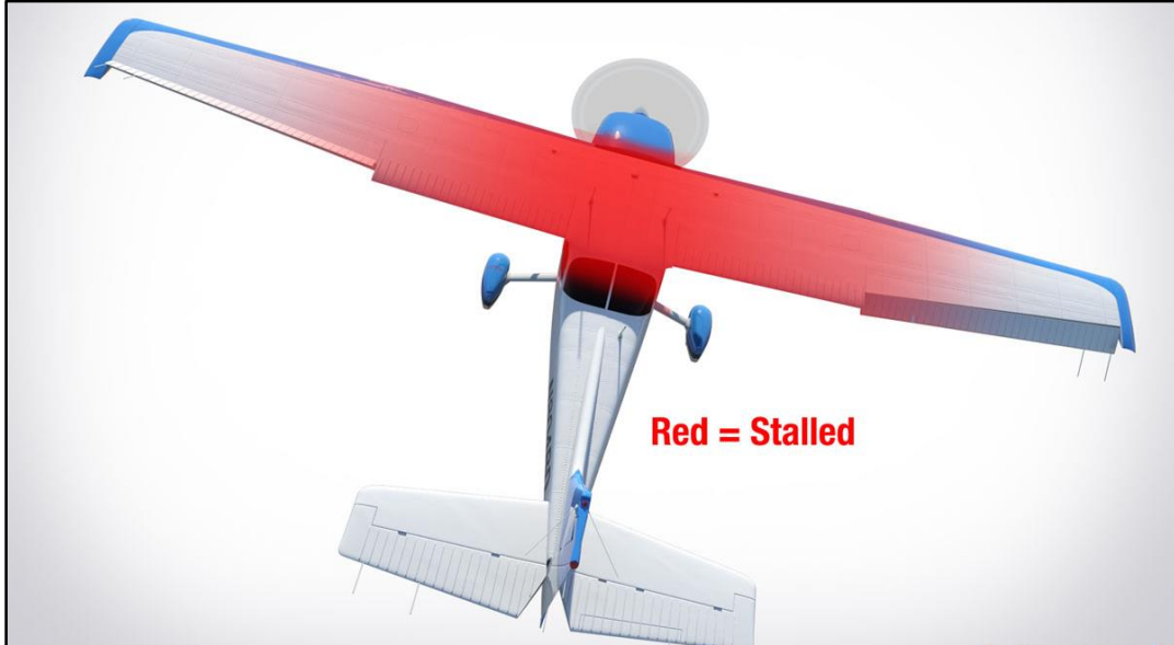
Şekil 1.7. Kanat burulma açısının taşıma kaybına etkisi [18]
