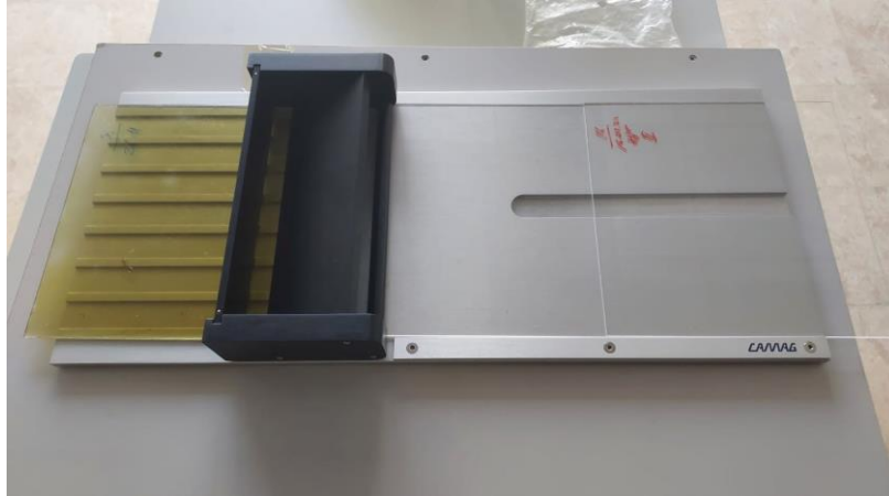
Fotoğraf 3.3. Plaka kaplayıcıda yayma yöntemiyle film üretimi
