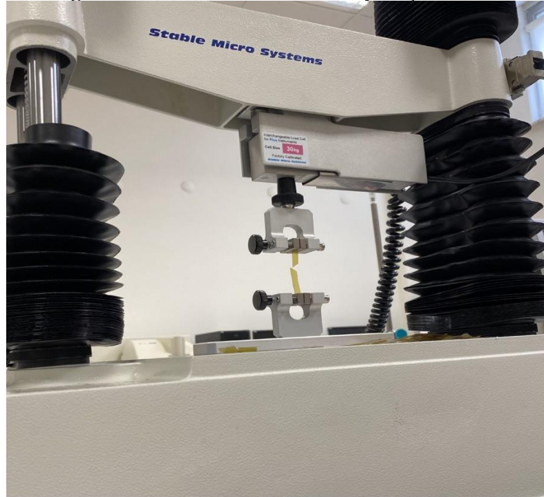
Fotoğraf 3.7. Tekstür analiz cihazında ölçümü yapılmış örnek
