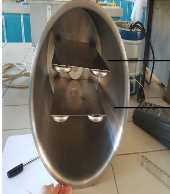
Şekil 3.2. Tepsi sıcaklığı kontrolü için tasarlanan raf sistemi
