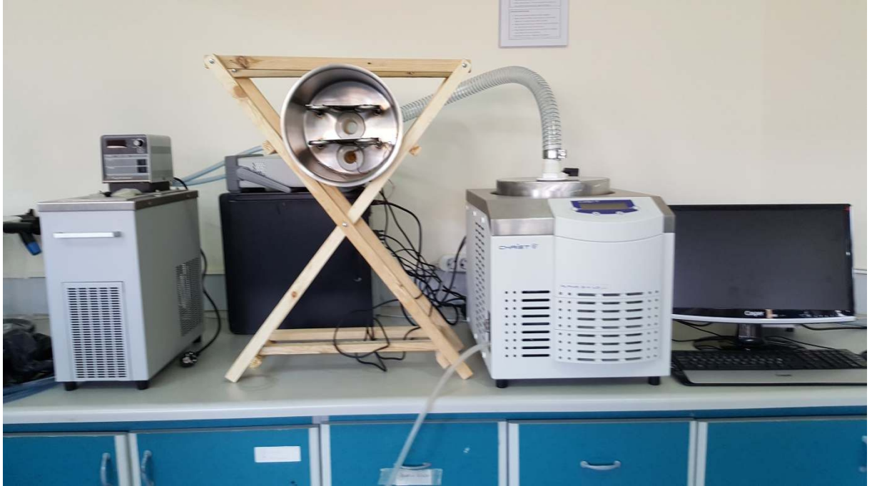
Şekil 3.4. Sıcaklık kontrollü dondurarak kurutma sistemi
