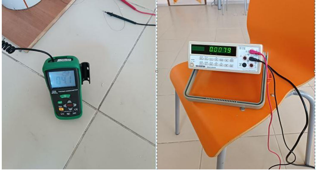
Fotoğraf 4.5. 4,1 m/s akış hızındaki ölçüm değeri
