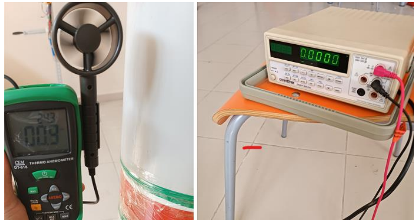
Fotoğraf 4.6. 0,9 m/s akış hızındaki ölçüm değeri
