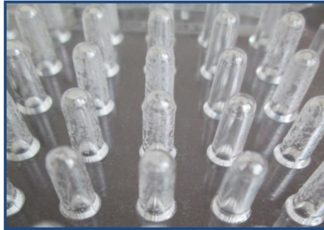
řekil 4.5. İęne kapaklarda biyofilm oluřumu. İęne uęlarında 48 saatlik inkubasyon sonrası makroskopik olarak kolonilerin gduřnümü. Saędan ikinci sıra negatif kontrolduř (blank).
