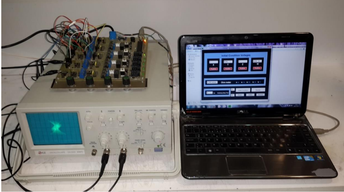
Şekil 5.15. Skala edilmiş Zhongtang kaotik sistemi devresinin KDDS ile gerçekteşmesi
