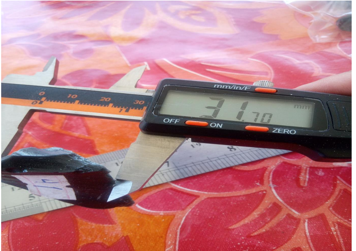
Fotoğraf 5.8. Elektronik hassa kumpas ile obsidiyen aşınma ölçümü (Harun Kurt kişisel arşivi)
