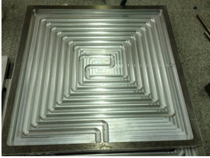
Şekil 6.21 : Üretimi yapılan soğuk levhadaki kanal geometrisinin görünümü.
