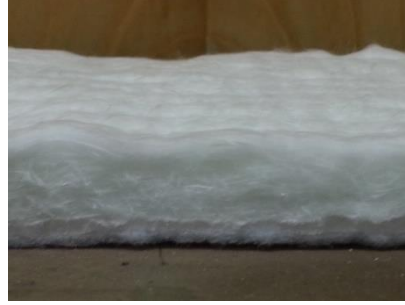
Şekil 4.15 : Cam-seramik hibrit malzeme (alttan sırasıyla 2 mm polyester, 6 mm seramik yünü, 12 mm cam yünü katmanları).
