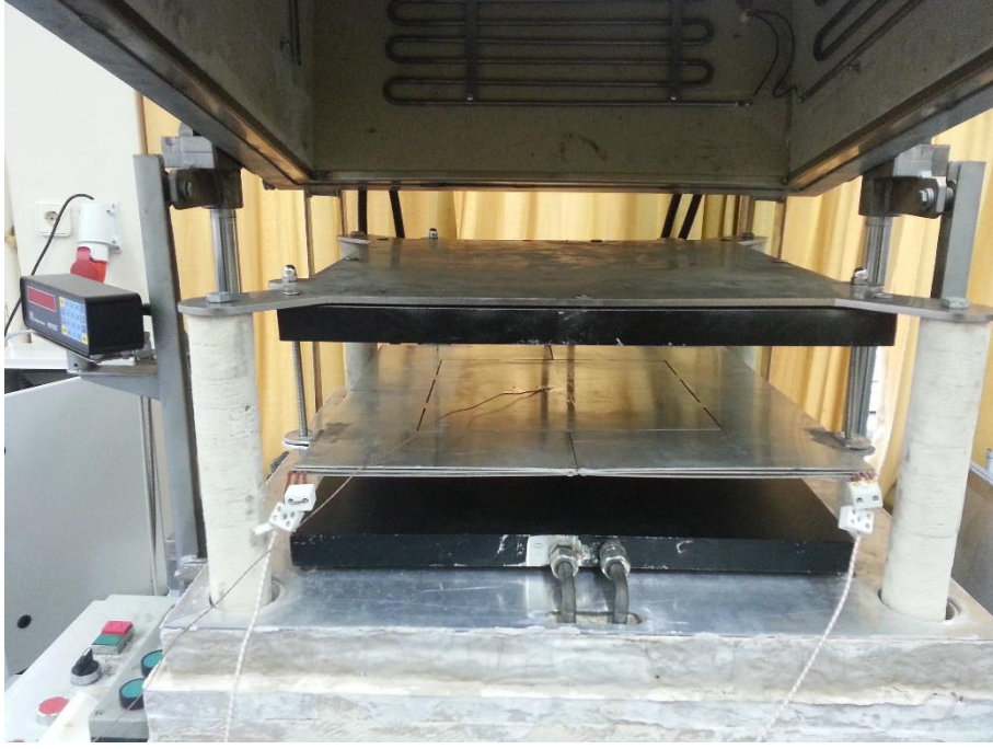
Şekil 6.4 : Sıcak levha ve soğuk levhaların cihaza yerleşimi.
