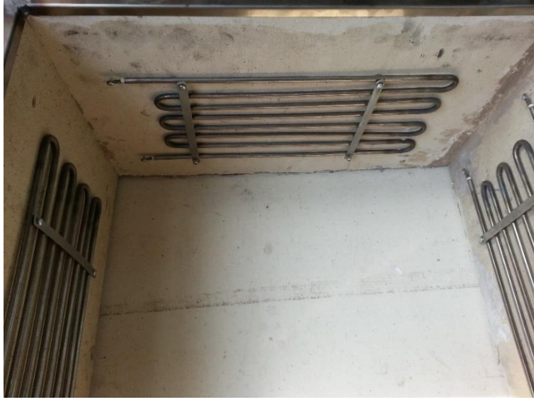
Şekil 6.2 : Boru tipi ısıtıcıların kapalı hacme yerleşimi.
