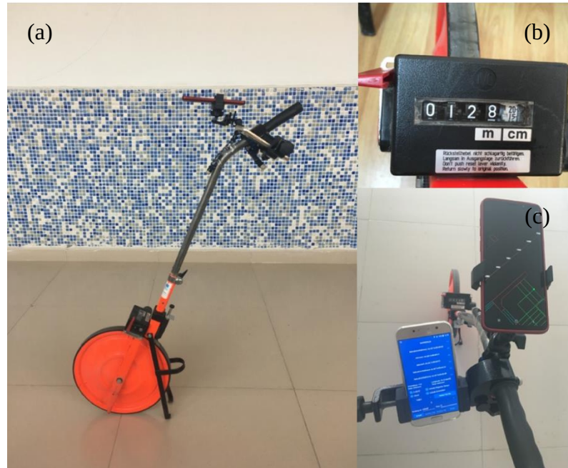
Şekil 2.3 Ölçü düzeneği (a), ölçü sayacı (b), veri toplayıcı ve kroki cihazları (c)
