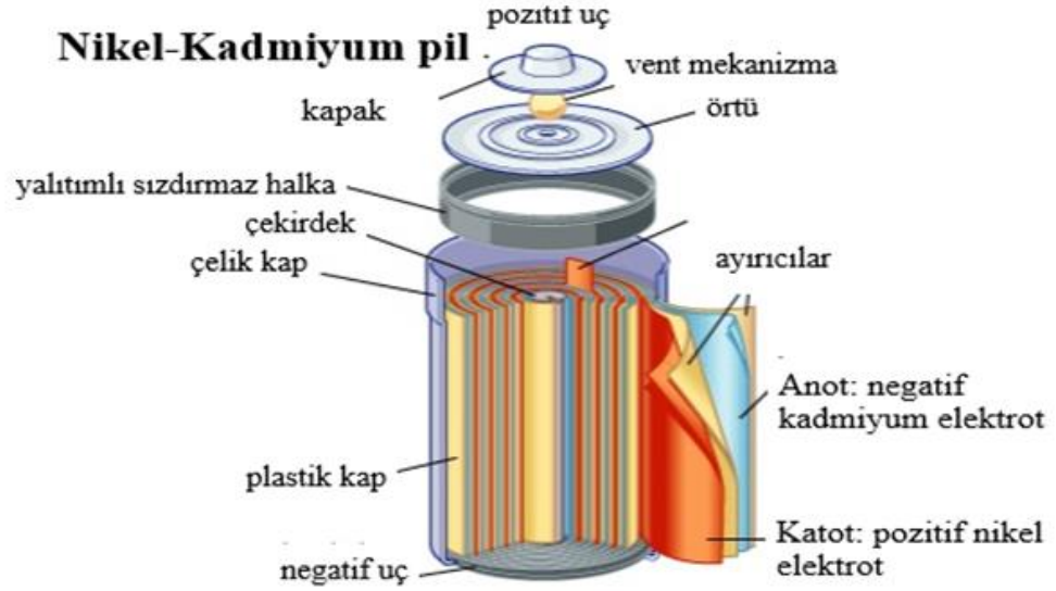
Şekil-1: Kadmiyum-nikel pillerin yapısı (220)
