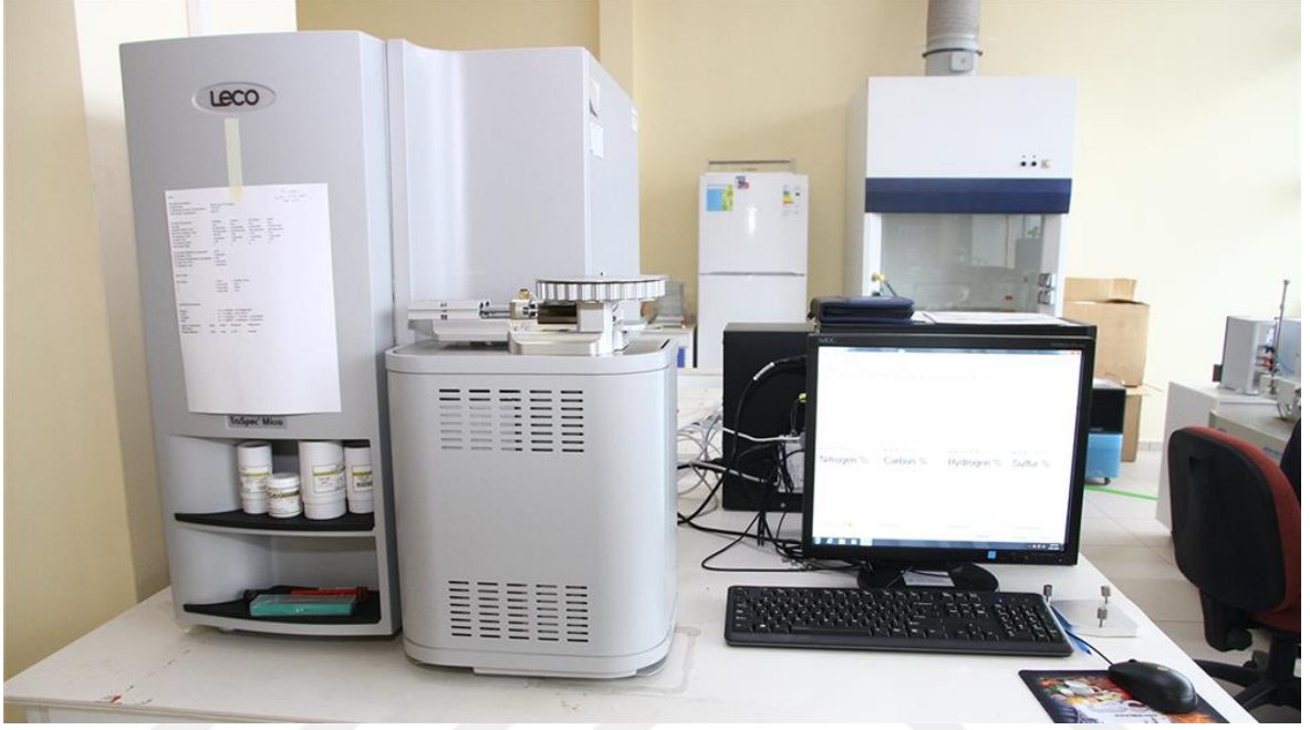
Şekil 2.6. Elementel analiz sistemi
