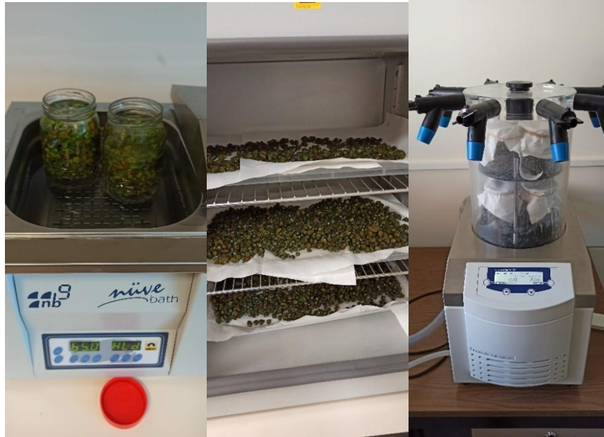
Şekil 3.1. Kaparilerin 65 °C'de acılık giderme ve kurutma işlemi
