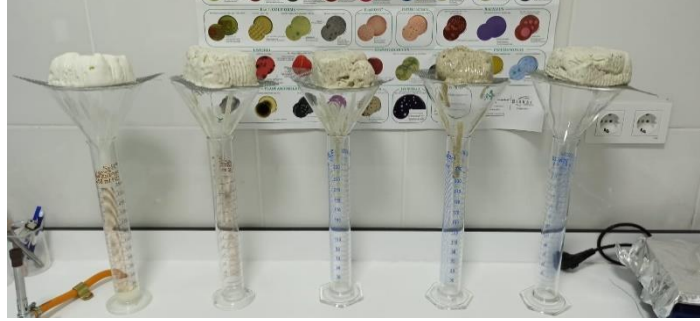
Şekil 3.5. 30. dakika erime oranının belirlenmesi
