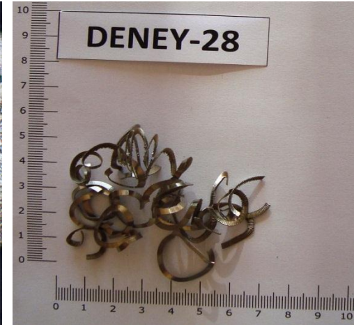
Şekil 7.26 V=165,03 m/dak kesme hızında, f=0,21 mm/dev ilerleme değerinde TiN kaplamalı kesici takım ile oluşan talaşın mikro ve makro görüntüleri.
