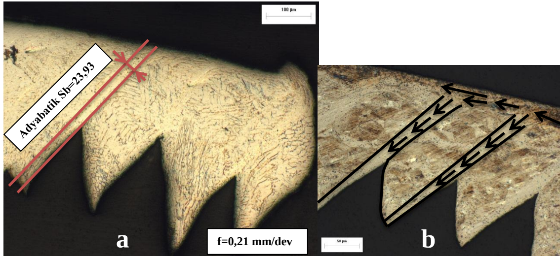
řekil 7.16 Kaplamasız (WC) kesici takım iin a) V=503,49 \text{ m/dak} kesme hızı ve ilerleme deđerlerine bađlı olarak Sb deđerimi b) Talařta kaymaya maruz kalan bđlgeler.
