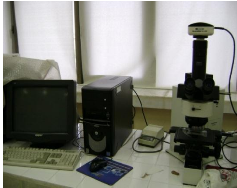
Resim 6.2 Numunelerin mikro yapı fotoğrafları için kullanılan optik mikroskop düzeneği.
