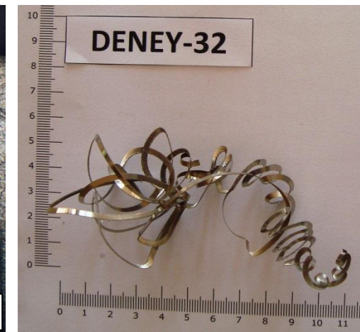
Şekil 7.27 V=237,20 m/dak kesme hızında, f=0,21 mm/dev ilerleme değerinde TiN kaplamalı kesici takım ile oluşan talaşın mikro ve makro görüntüleri.
