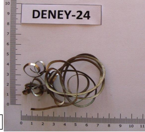
Şekil 7.25 V=113,28 m/dak kesme hızında, f=0,21 mm/dev ilerleme değerinde TiN kaplamalı kesici takım ile oluşan talaşın mikro ve makro görüntüleri.
