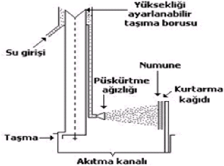
Şekil 1.34 AATCC yağmur testi(Horrocks ve Anand, 2000)
