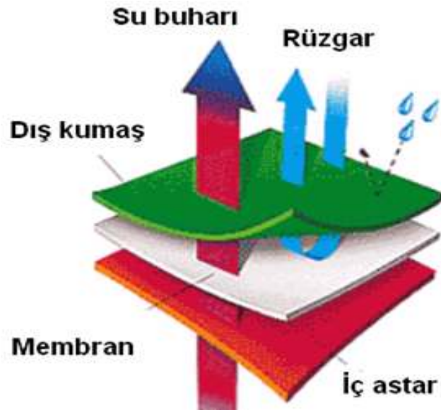
Şekil 1.25 Su geçirmez nefes alabilen lamine kumaş yapısına örnek(Quality Testing, bt)
