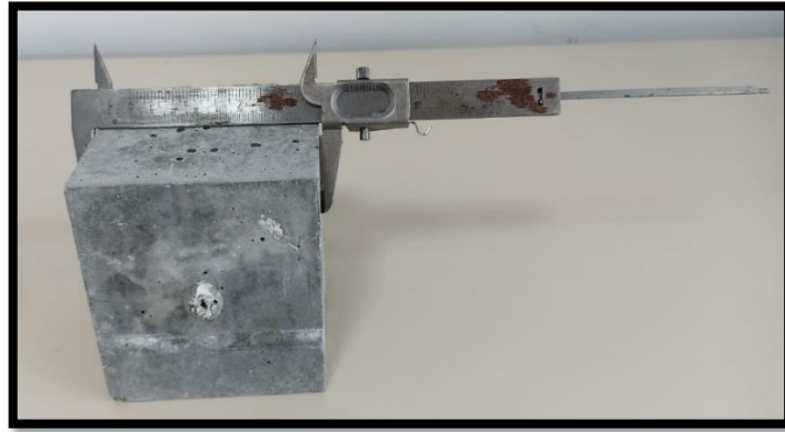
Şekil 3. 15. Kumpasla ölçümü yapılan beton numunesinin kuru birim hacim ağırlığı.
