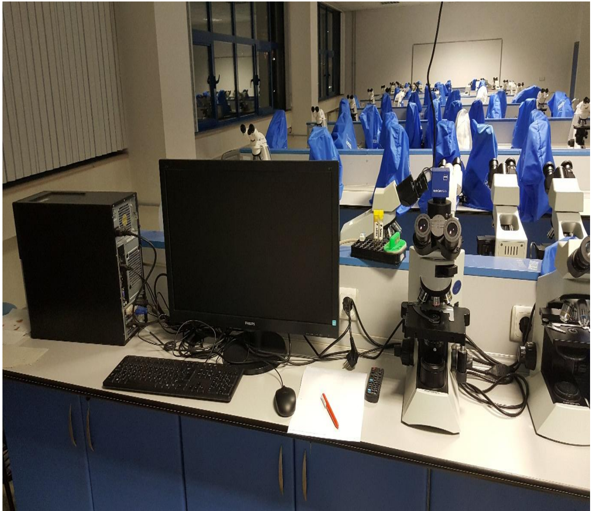
Şekil 3. 2. Analiz işleminde kullanılan kamera ataçmanlı ışık mikroskobu ve bilgisayar düzeneği
