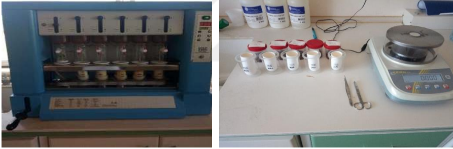
Şekil 3.6. Yağ analizi için kullanılan Soxhlet Cihazı ve Soxhlet Kartuşları (Orijinal)
