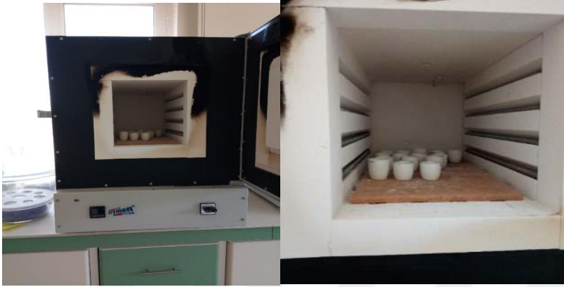
Şekil 3.8. Kül analizi için kullanılan kül fırını (Orijinal)
