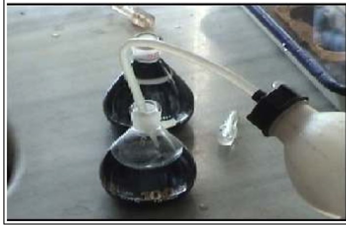
Şekil 3.19 Bağlayıcı özgül ağırlığının piknometre ile tespiti
