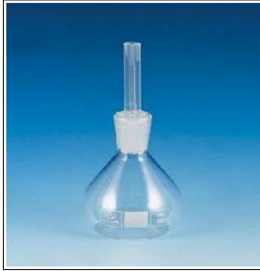
Şekil 3.8 Özgül ağırlık tespiti için kullanılan piknometre
