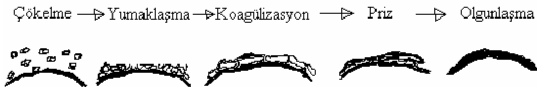
Şekil 3.10 Asfalt emülsiyonları için kesilme mekanizması (Özen, 2004)
