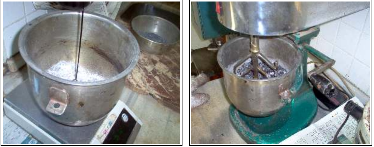
Şekil 7.2 Değişik kireç yüzdelere göre karışımların hazırlanması
