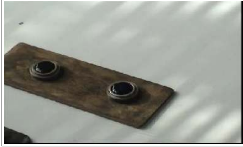
Şekil 3.14 Halka içinde hazırlanmış olan deney numuneleri (Özen, 2005)
