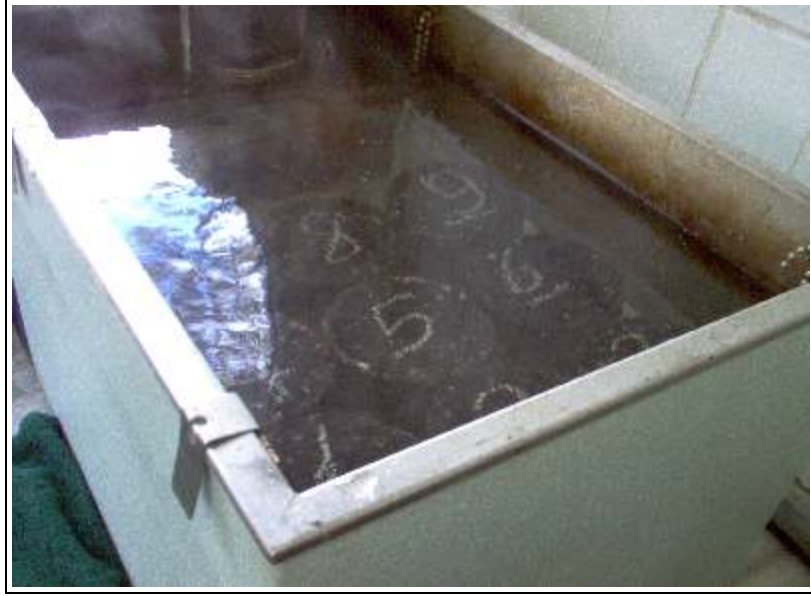
Şekil 7.7 Marshall numunelerinin su banyosunda koşullandırılması
