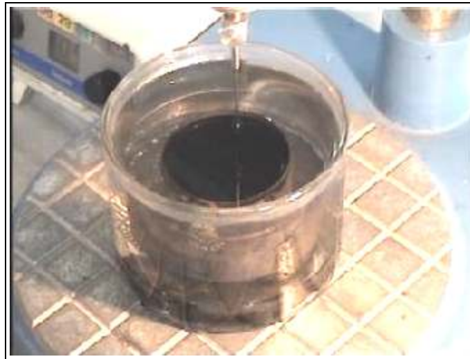
Şekil 3.11 Penetrasyon deney düzeneği (Özen, 2005)
