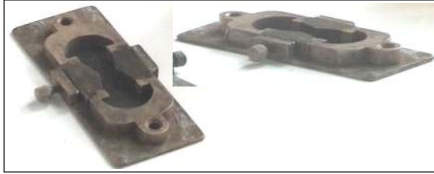
Şekil 3.13 Düktilite deney düzeneğinde kullanılan pirinç kalıplar (Özen, 2005)
