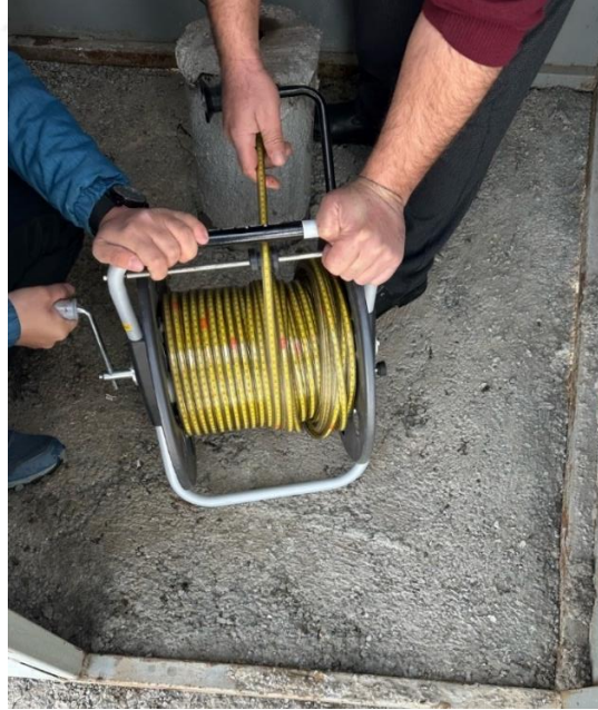
Şekil 2.2. Su sondaj kuyularında statik seviye ölçümüne yarayan düdüklü metre
