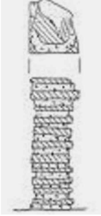
Şekil 5.12. Yapının sıcaklık mekanının döşemesini taşıdığı düşünülen tuğla ayak (pilae) örneği [22]
