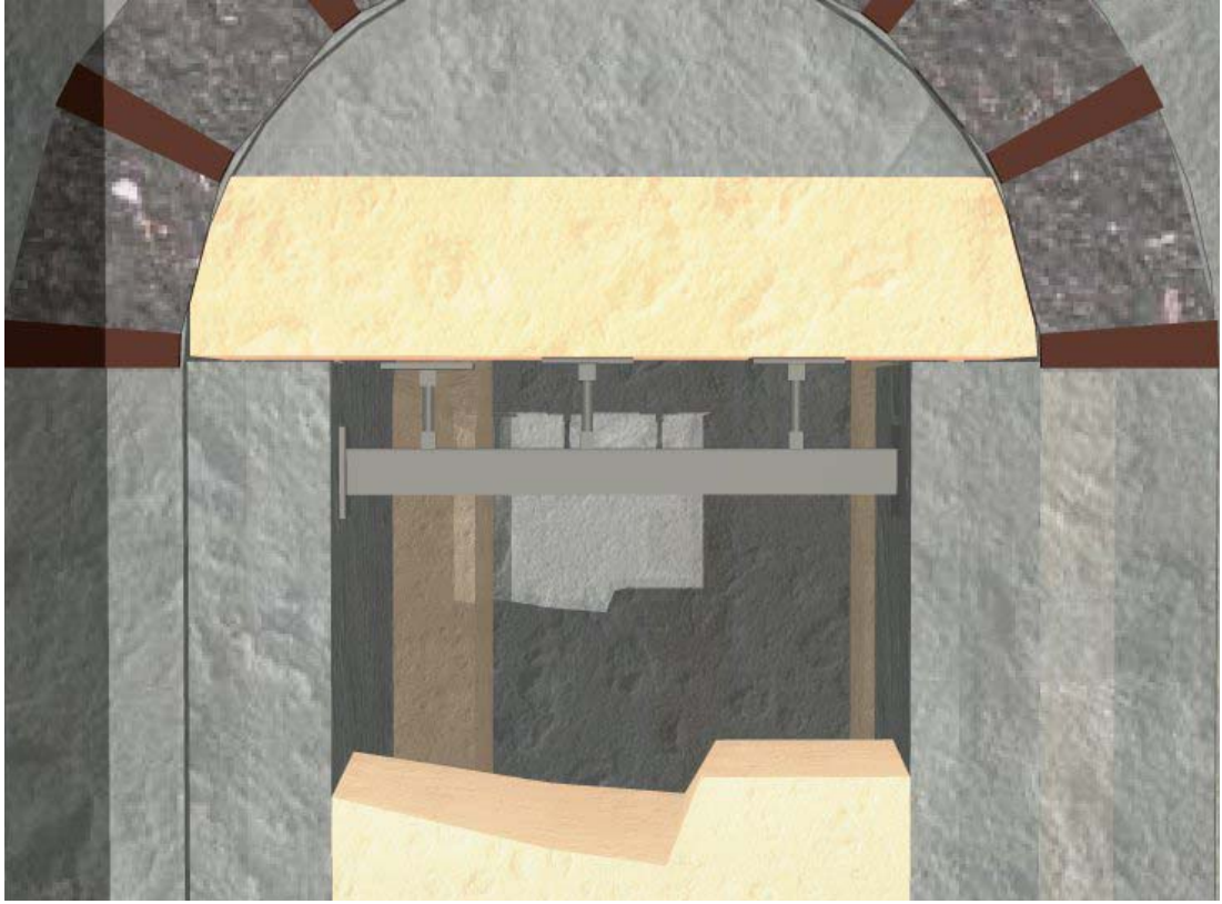
Şekil 6.10. Lento taşını sağlamlaştırmak için kullanılan çelik taşıyıcı strüktür (Çizim: Biçer)
