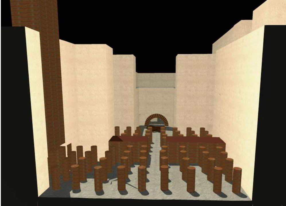
Şekil 5.13. Yapının cehennemlik katını ve ocağı gösteren bir restitüsyon çizimi (Çizim: Biçer)
