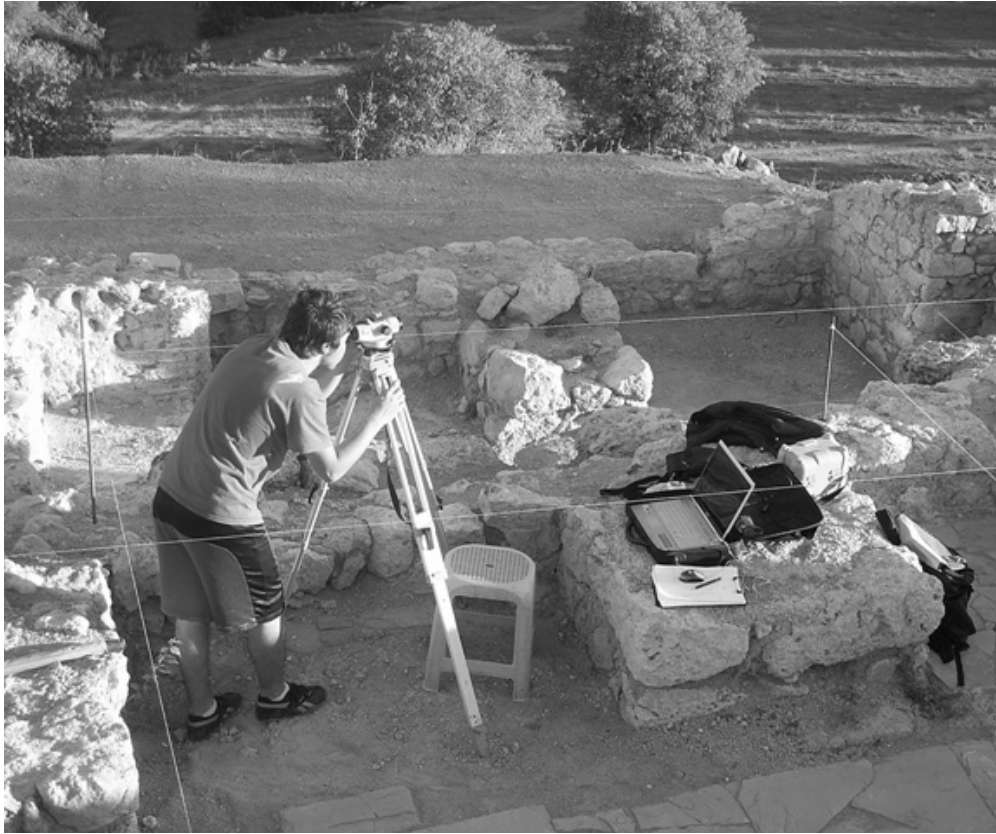
Resim 3.1. Yapının rölöve çizimlerinin hazırlanması için yapılan ölçü alma çalışması (Fotoğraf: Biçer)
