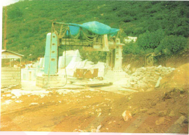
Şekil.3.47 Stok alanı içerisinde monte edilmiş monolama
