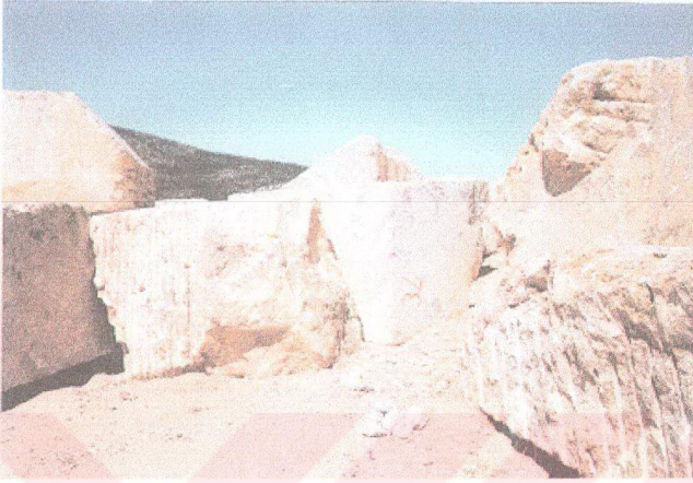
Şekil.3.28 Blok stok sahasında gözlenen kompresör sistemi (düşey oluk izleri gözlenen) ve tel kesme sistemi ile üretilmiş bloklar.
