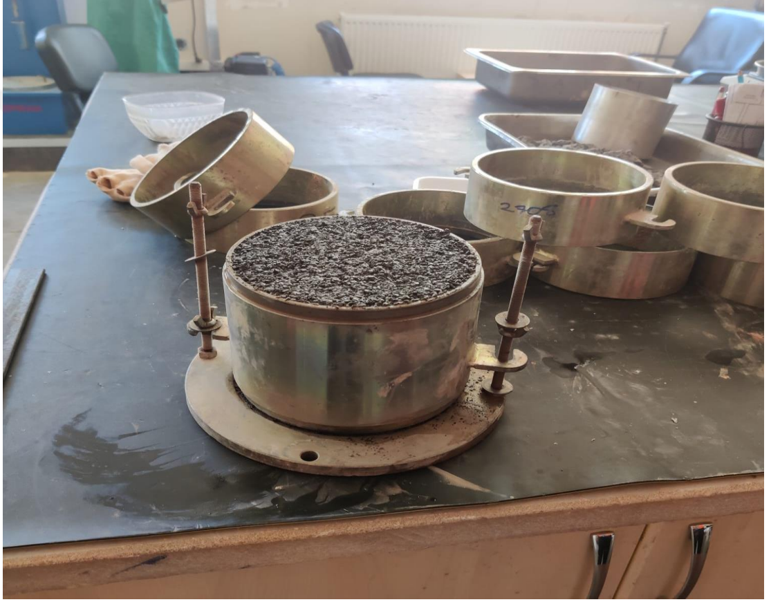
Şekil 4.9: CBR Deneyi Sonucu Malzemenin Son Hali
