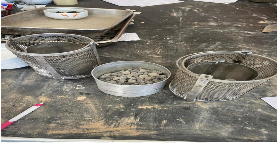
Şekil 3.7: Hava Tesirlerine Karşı Dayanım Deney Aletleri
