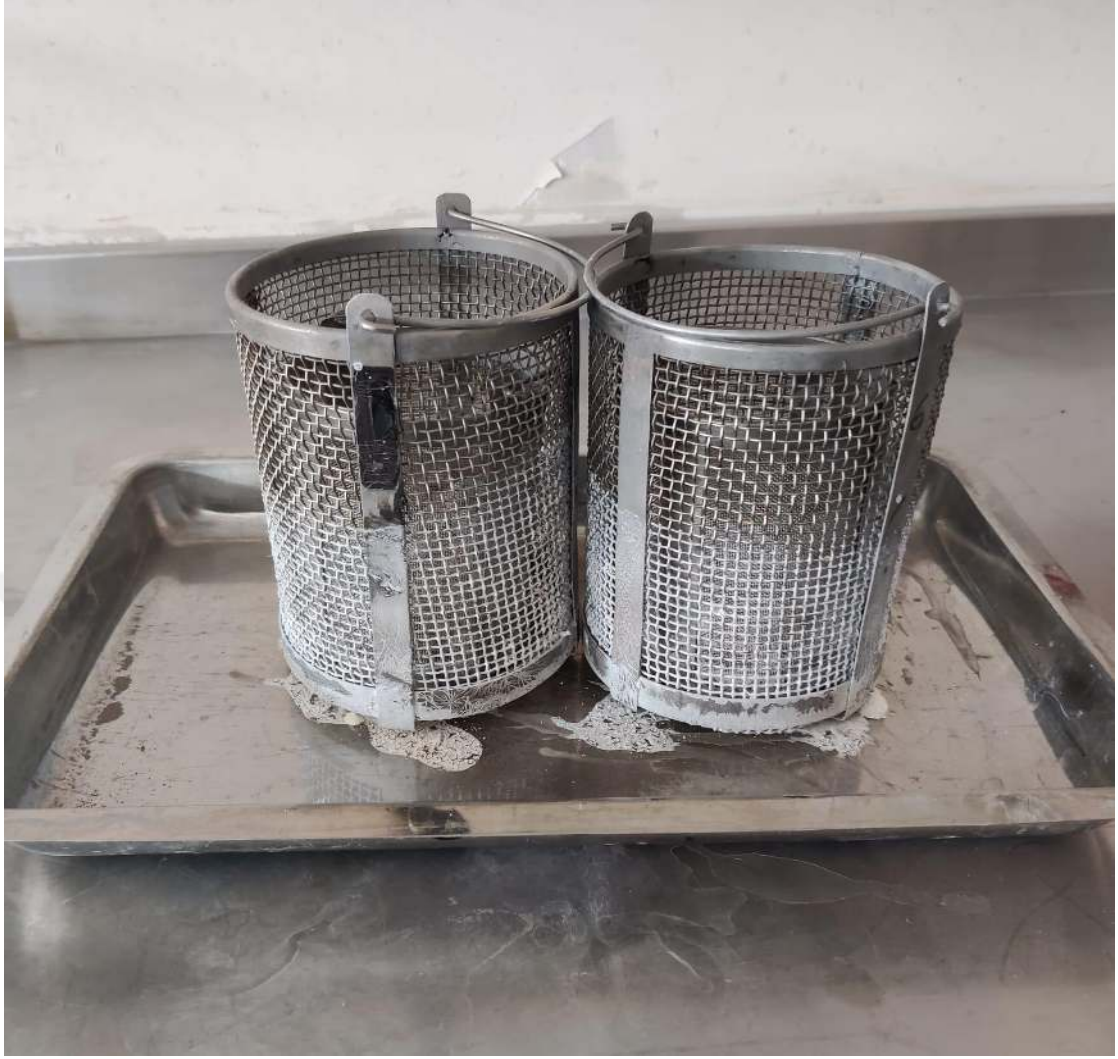
Şekil 4.7: MgSO 4 Deneyi Malzemelerin Sepetteki Son Hali
