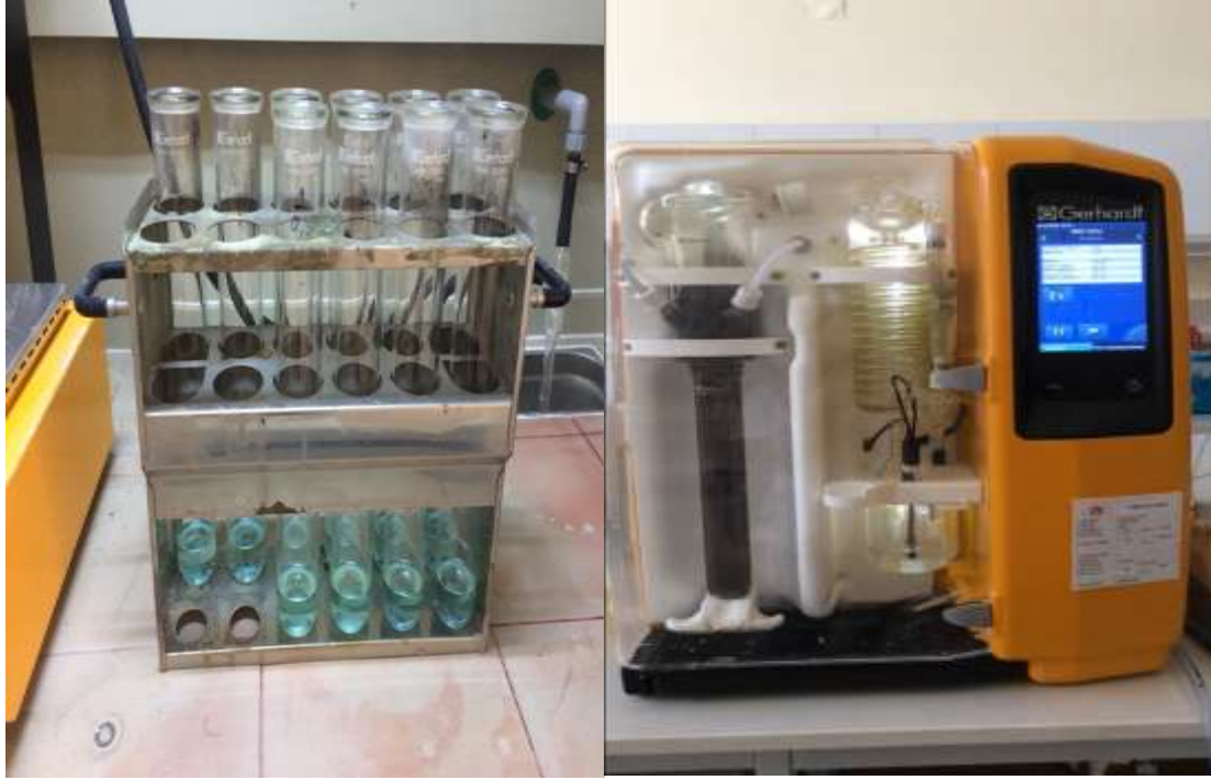
Resim 3.1 Azot analizi yakma işlemi ve Kieldahl cihazı.
