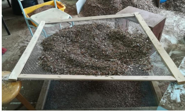
Şekil 2.10: Kabukların eleme işlemi
