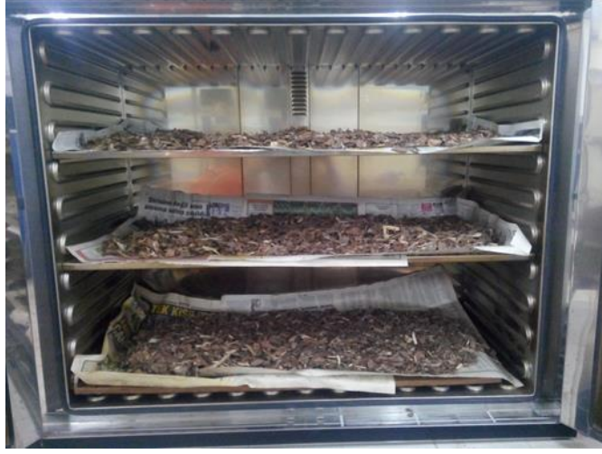
Şekil 2.9: Kabukların kurutma fırınında uygun rutubete getirilmesi
