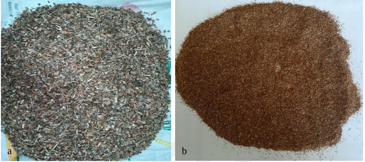
Şekil 2.6: Kimyasal analizde kullanılan karaçam kabukları (a: Öğütme öncesi, b: Öğütme sonrası)
