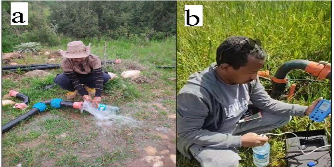
Şekil 3.2. (a) Hidrojeolojik çalışmalar için su örneği alımı ( b ) pH ölçümü
