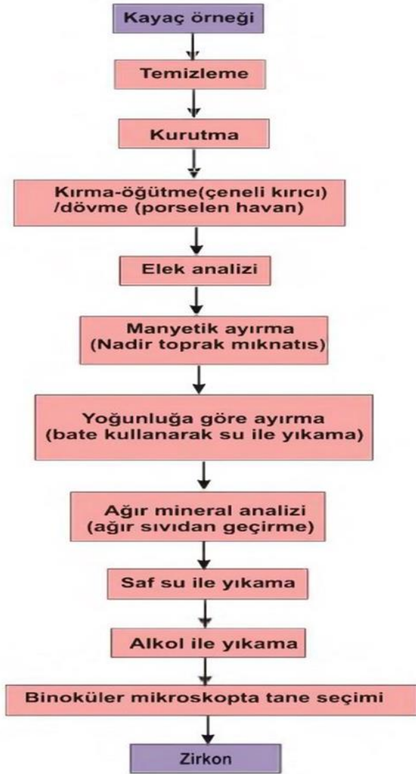
Şekil 2.1. Zirkon mineralini ayırma işlemindeki işlem sırasına göre akış şeması.
