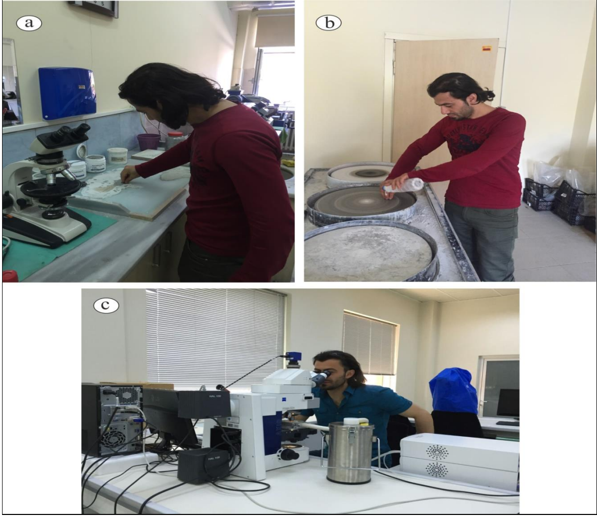
Şekil 2.1. a) Aşındırıcı tozlar ile kesitlerin hazırlanması b) Alimünyum oksit tozu ve elmas solüsyonun kullanılması c) Sıvı kapanım ölçümlerinin yapılması
