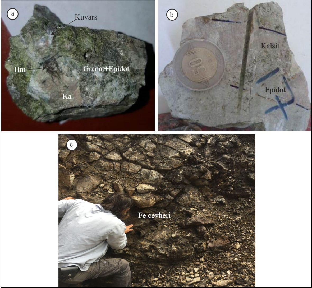
Şekil 3.21. Karadağ Fe-Cu skarn cevherleşmesi ekzoskarn zonunda a) Granat-epidot-kalsit-kuvars-hematit birlikteliği, b) Epidot-kalsit birlikteliği ve c) Fe cevherinin arazideki görünümü. Ka: Kalsit, Hm: Hematit
