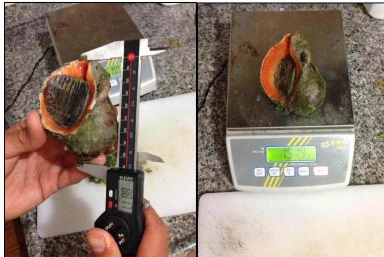
Şekil 4.2.5.2.1. Dijital Kumpas ile Boy ve Elektronik Terazi ile Ağırlık Ölçümü (Orijinal)
