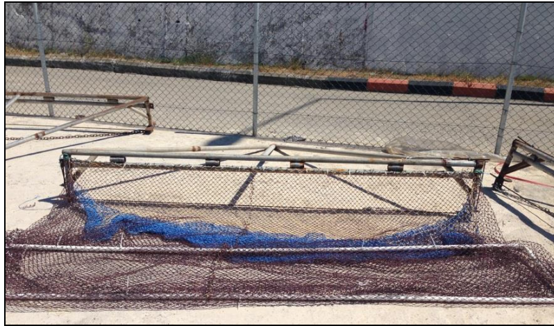
Şekil 4.1.4.1. Denemelerde Kullanılan Donatılmış Algarna (Orijinal)
