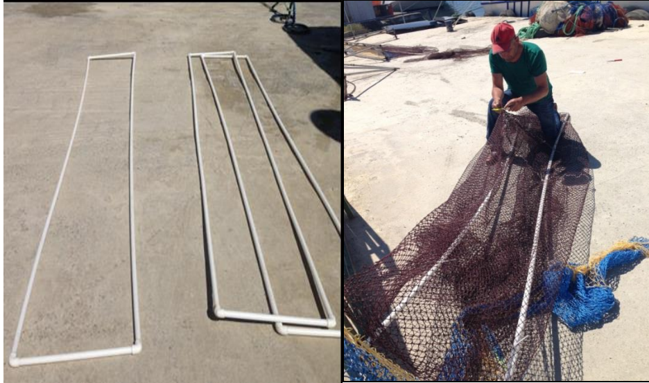
Şekil 4.1.3.1. Plastik Çerçeve ve Örtü Torba Dizaynı (Orijinal)
