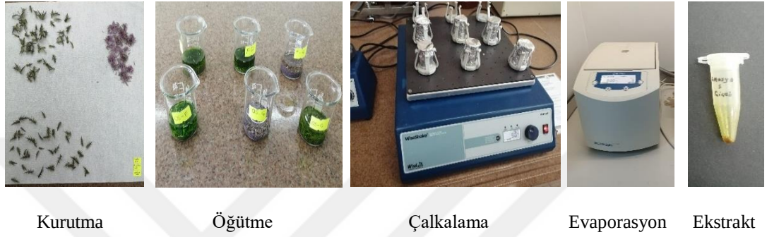
Şekil 3.6. Fenolik bileşiklerin analize yönelik örnek hazırlama aşamalarına ait genel görünüş
