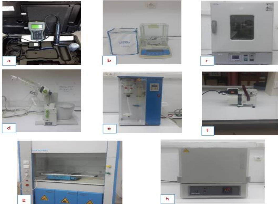
Şekil 4.17. Kimyasal analizlerde kullanılan cihazlar (a: Hanna marka HI 9829 model su ölçüm cihazı, b: Radwag Marka Hassas Terazi, c: Santez marka SE-65 model etüv d: Buchi marka R-3000 model marka Dinamik Rotary Evaporatör Seti, e: Eflab marka destilasyon ünitesi, f: KNF marka N022 AN 18 model vakum pompası, g: Kjeldahl marka yakma ünitesi ve Mikrotest marka çeker ocak, h: Protherm marka kül fırını)
