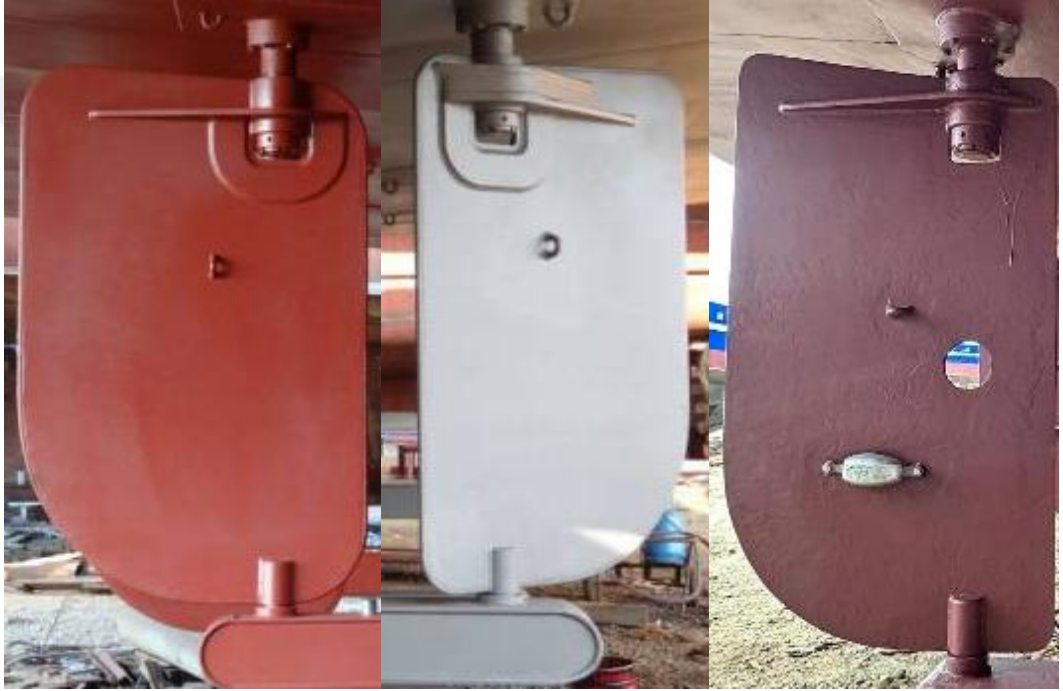
Şekil 2. Mevcut dümen tasarımlarına örnekler
