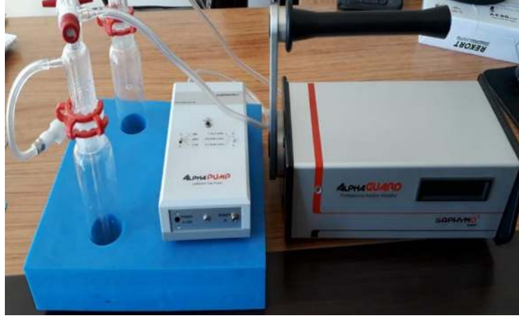
Şekil 6.2 Saphymo marka AlphaGuard model aktif radon monitörü
