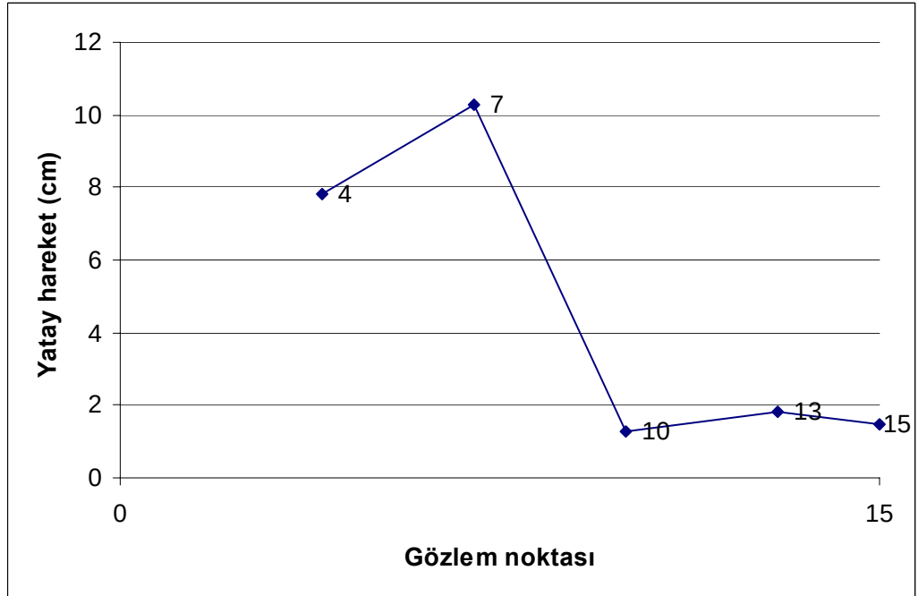
Şekil 4.9 CC ocak kesiti üzerinde bulunan gözlem noktalarındaki yatay hareketler
