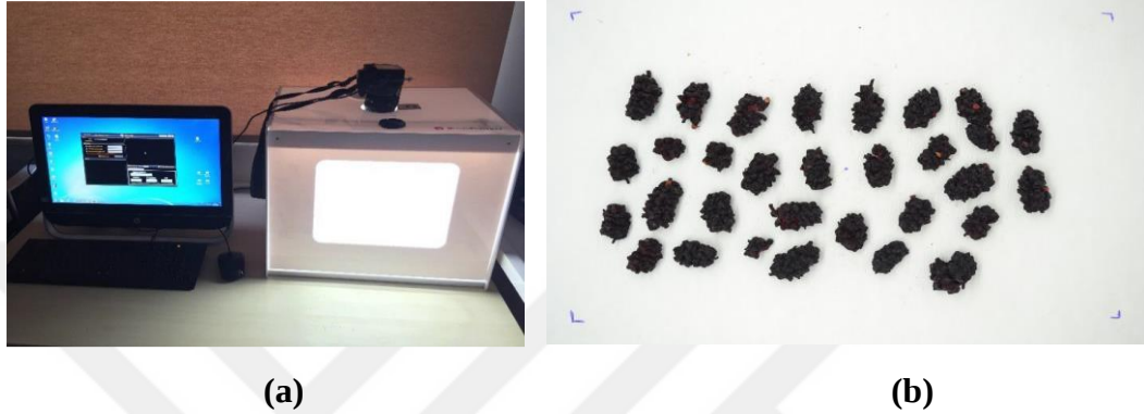
Şekil 3.2. a)Ürünlerin renk analizi için görüntülendiği sistem; b)Kurutulmuş karadut meyvelerinin renk analizi görüntüsü
