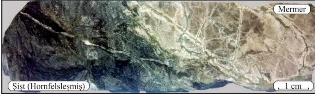
Şekil 3.5. Alıçlı Formasyonuna ait hornfelsleşmiş şist ve mermerleşmiş re-kristalize kireçtaşı dokanağı Yonca yolu formasyonuna ait şist ve mermer dokanağının karot görünümü
