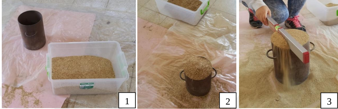
Şekil 3. 15. Yığın yoğunluğu belirleme yolu aşamaları
