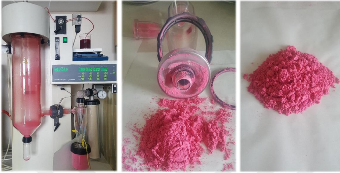
Şekil 3.6. Püskürtmeli kurutucu ile toz renklendirici eldesi, (Püskürterek kurutma (solda), toplama kabından alınan ürün (ortada), son ürün (sağda))
